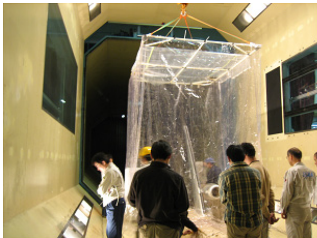
大型風洞に設営された塗装ブース
