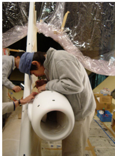
図 2-4 マーカーの取付け作業
