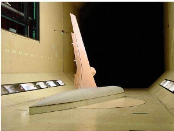
図 5-3 PSP 塗装された模型の写真
