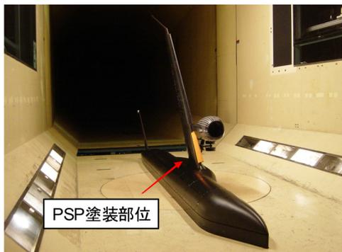
図 5-28 低速試験用 MRJ 半裁模型
