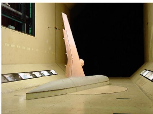
図1 PSP 塗装された風洞模型
