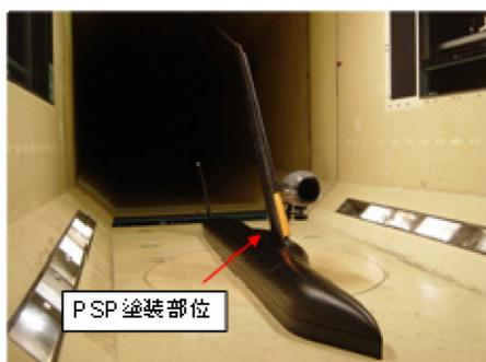
図1 MRJ 低速風洞模型 @LWT1
