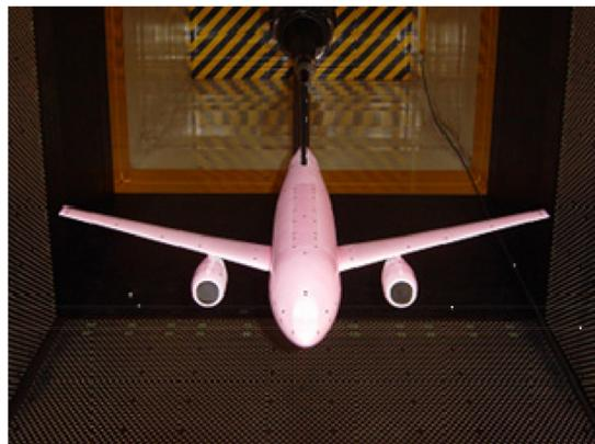
図 1-2 PSP 塗装された風洞模型
