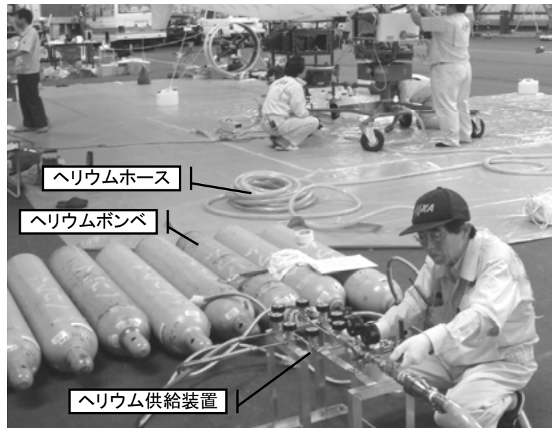
図 2.3.2-16 ヘリウム供給装置の接続状況
