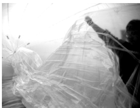
図 2.1.4-2 ヘリウム注入中の外袋および内袋
