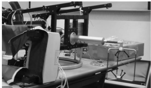
図 2.3.3-7 超音波風速計装備状況
