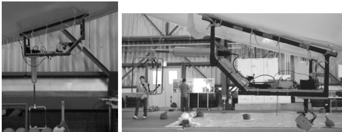
図 2.1.3-6 超音波風速計初期型(左), 屈曲型(右) 装備状況
