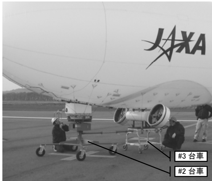
図 2.3.2-15 ゴンドラに装着された地上装置
