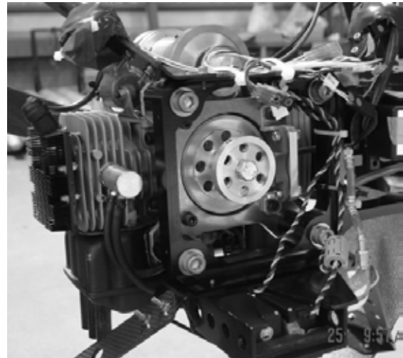
図 3.4.2-2 12m 級飛行船エンジンスタータ
