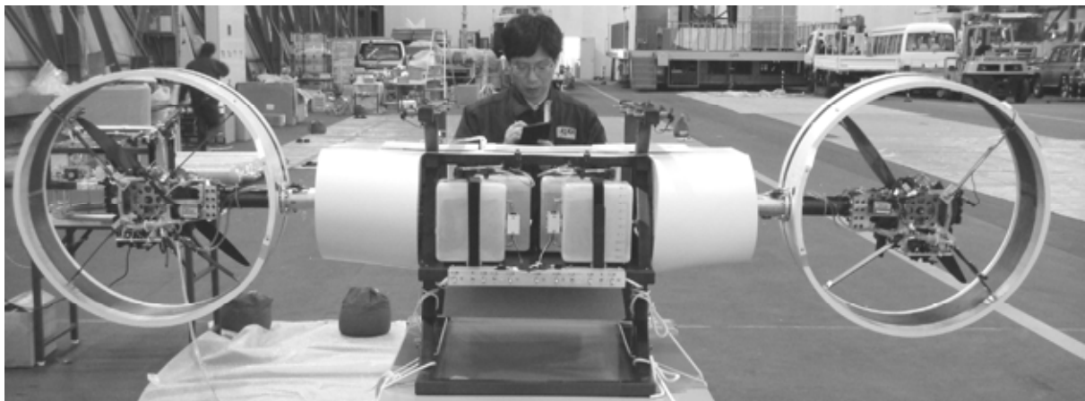
図 2.3.2-11 推進器構体(フェアリング, 初期型プロペラガード装備:後方より)
