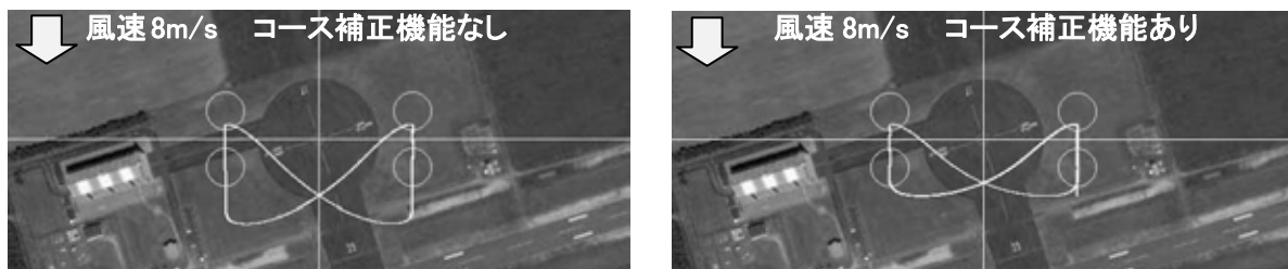
図 3.1.2-1 コース補正の有無による、風下への偏差の違い
