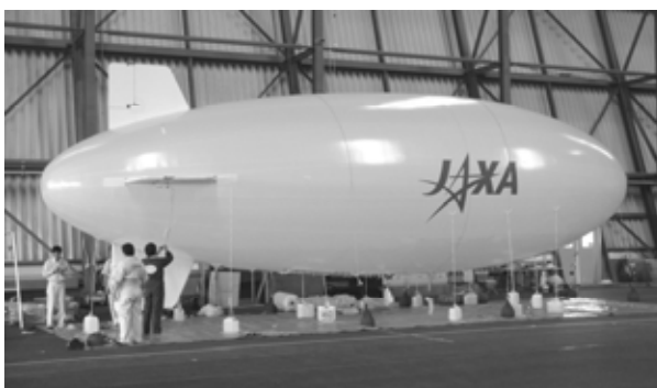
図 2.1.4-4 構体懸垂前の船体固縛状況
