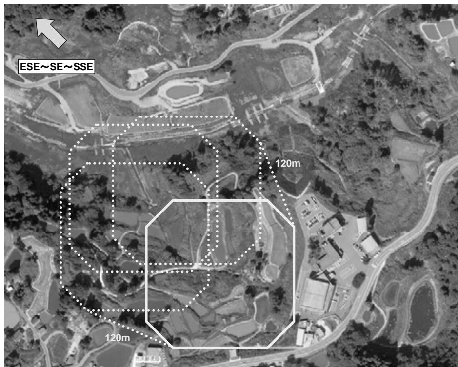
図 2.2.5-14 南東風 3m/s の場合の飛行空域(実線)設定と漂流時の不時着範囲(点線)
