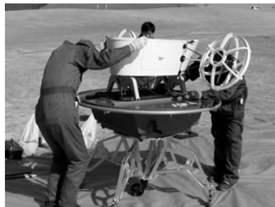
図 2.2.3-2 地上運用装置 (推進器 Gondola を搭載した状態)
