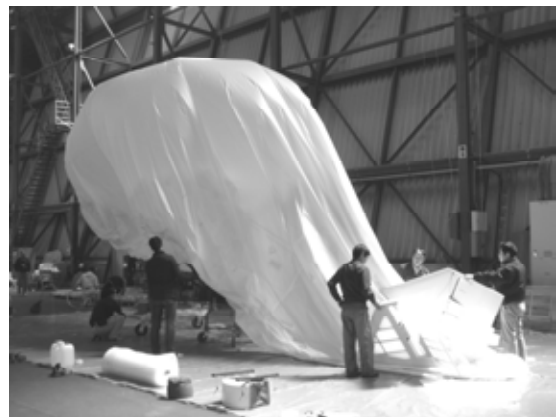
図 2.3.4-2 注入中の状況と尾翼の養生
