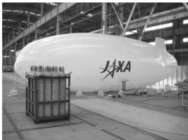
図 2.1.4-1 ヘリウム注入中の船体
