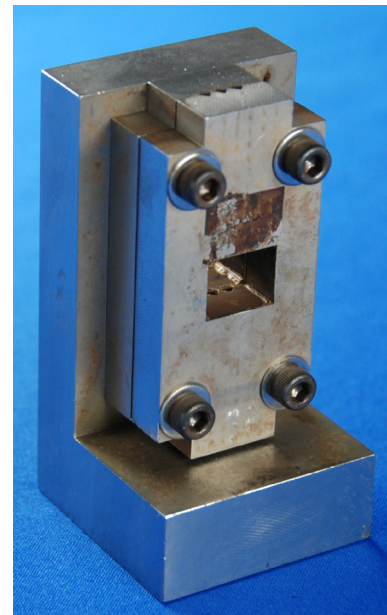
図 25 DNS 試験の治具
