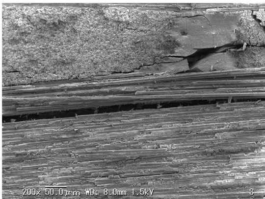
(K) 195°C,2000 時間曝露, 室温試験
