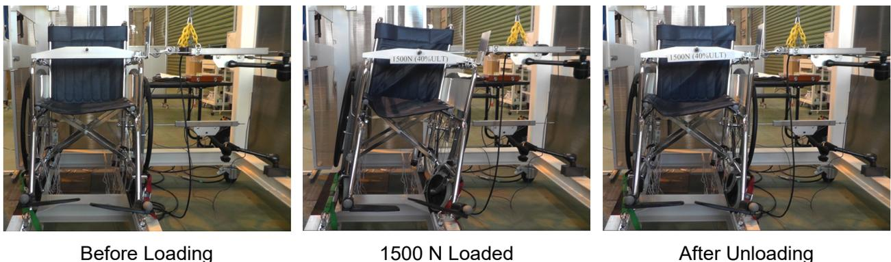
図 45 横方向荷重負荷時の車椅子の負荷前、1500 N 負荷時、除荷後の状況
