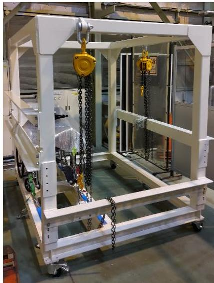
図 40 車椅子の静強度試験用架構
