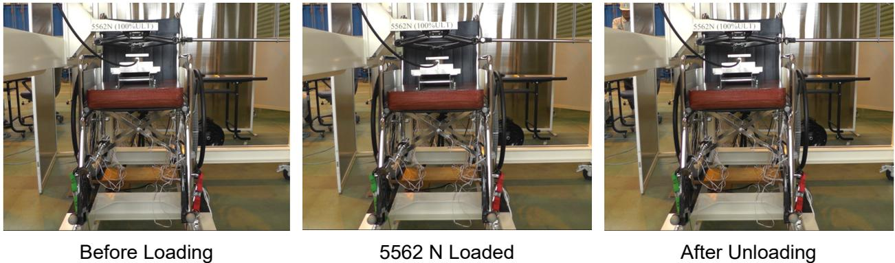
図 46 下方向荷重負荷時の車椅子の負荷前、規定荷重（5562 N）負荷時、除荷後の状況
