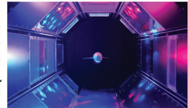
6軸を制御することによる浮遊している有翼模型 (AGARD-B model)
