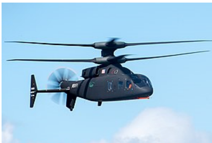
図2 同軸反転ロータ型コンパウンドヘリコプタ (シコルスキー・ボーイング SB>1 デファイアント)
