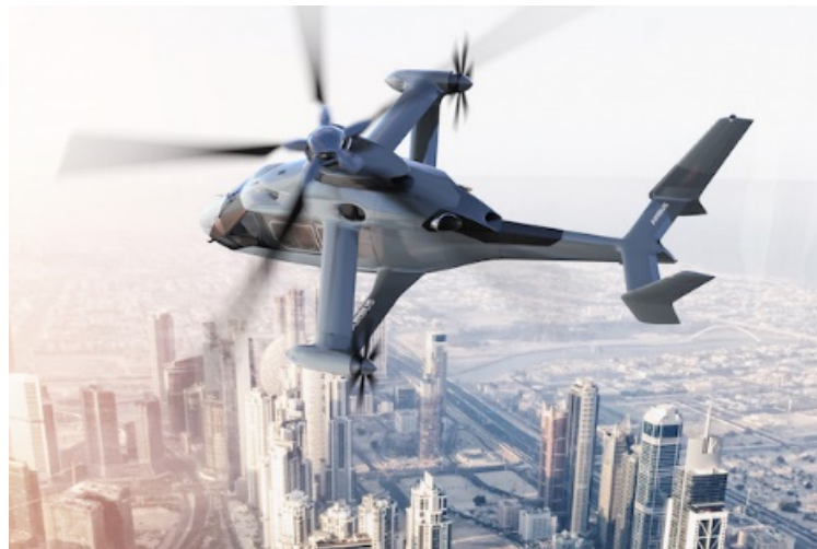
図 1 シングルロータ型コンパウンドヘリコプタ (エアバスヘリコプターズ RACER)
