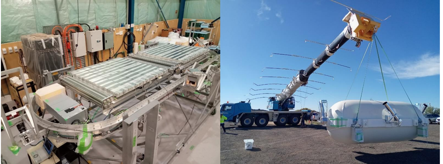
図1：（左図）全機器・全エマルジョンフィルム搭載完了時（断熱材搭載前、与圧容器シェルを閉じる前）。与圧容器ゴンドラにローラー駆動型多段シフター2台を搭載し、そこにコンバーター全20パックを搭載している。全有感面積は2.5m 2 （1.25m 2 ×2セット）。両半円部に各機器のコントローラ、通信機器、電池を搭載。与圧容器リングの円弧部と直線部の外側には3方位を向いたスターカメラを搭載。長手方向の全長5.7m。（右図）与圧容器シェルを閉じた後、最終かみ合わせ時。3方位を向いている銀色の筒がスターカメラの迷光除けフード。
