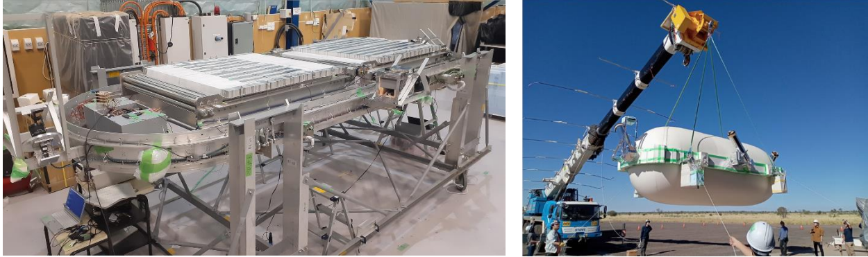
図6. (左)フィルム搭載後のエマルジョン望遠鏡(右)感度試験の様子
