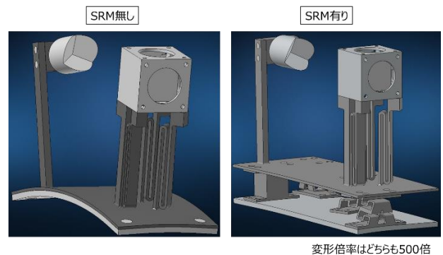
図 3 SRM 無しと有りの場合の変形の様子 ( \Delta T = -50^\circ\text{C} )
