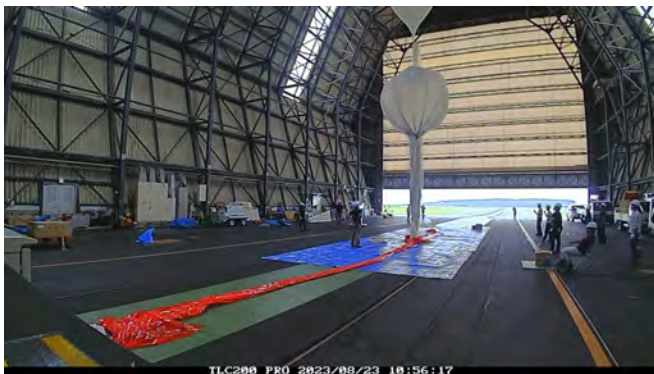
図 4: カラーより上には十分なガスが詰められる。
