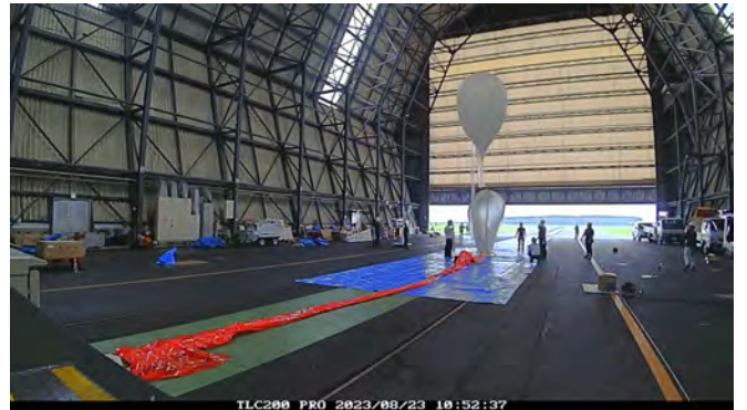
図 3: ガス注入に伴い、気球頭部が持ちあがる。
