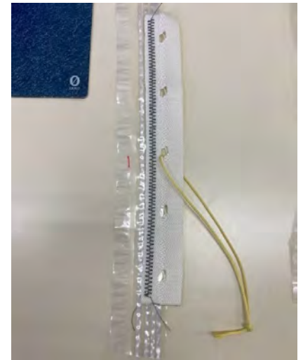
図 1: 左図: ネクタイ部の構造。予め穴ができるように編んだテフロン製ループテープを気球のロードテープに縫い付け、穴を通した紐でロードテープ同士を拘束する。右図: ネクタイ部のロードテープとテフロン製ループテープとの結合部の写真。テフロン製ループテープの穴をつらぬくようにロープを通し、ロードテープを拘束することでフィルムの広がりを防止する。開放時には、カッターを駆動する。
