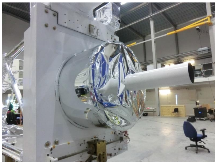
図 3：熱環境のため望遠鏡の周囲に巻いた SLI。背面も同様。隙間なく配置したことで、着陸後の降雨でも望遠鏡内部への浸水は見られなかった。
