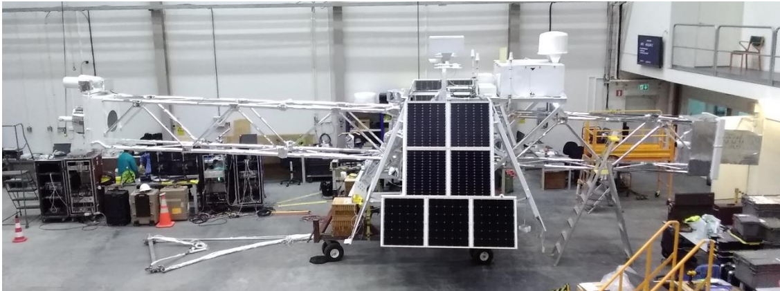
図 1：XL-Calibur 気球の全体写真。2022 年 7 月にスウェーデンから放球し、カナダまで 6 日間のフライトを実施した。全長~12m。左：硬 X 線望遠鏡、右：偏光計。2024 年の北極圏フライトも、同じ構成で実施する。
