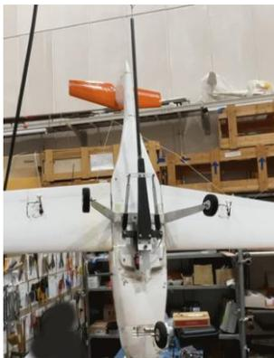
図 8 MPSB 装置取り付け状態での懸吊試験
