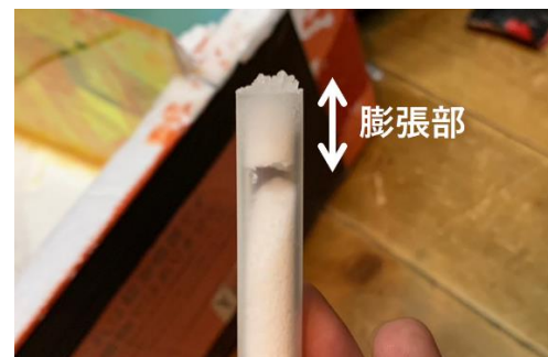
図5 回収後の通気水密管の様子
