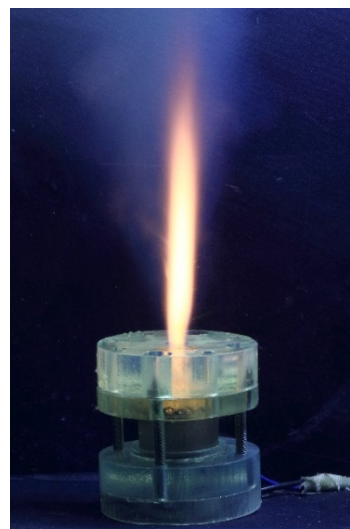
第1図 燃焼器での着火の様子
