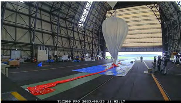
c) さらにガス注入。
