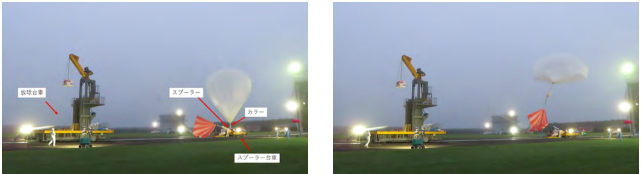
図 1: NPB2-3 気球 (B20-03 実験) の放球時の映像 (左はスプーラー解放時、右はその 2 秒後)。
