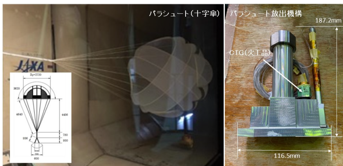
図10：本試験に使用したパラシュート（左）とパラシュート放出機構（右）
