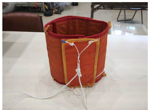
図 11: ミニカラーの写真。左図にあるように、ベルト部(左)とベルクロ部(右)からなり、右図のように気球に巻き付けて利用する。右図中央にあるベルクロ部に結合された紐を引っ張ることで、ベルクロ部はベルト部から離れ、ベルト部と共に気球から分離する。ベルト部とはベルクロ部とは十分に余長のある紐で結合されている。
