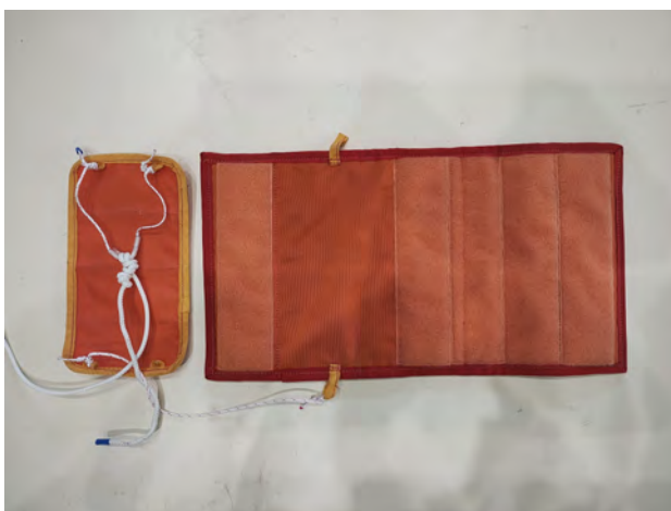
図 11: ミニカラーの写真。左図にあるように、ベルト部(左)とベルクロ部(右)からなり、右図のように気球に巻き付けて利用する。右図中央にあるベルクロ部に結合された紐を引っ張ることで、ベルクロ部はベルト部から離れ、ベルト部と共に気球から分離する。ベルト部とはベルクロ部とは十分に余長のある紐で結合されている。
