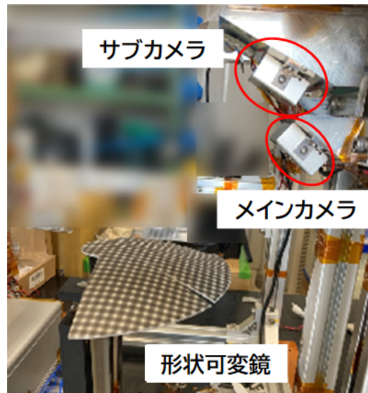
図9 格子貼付1カメラ法による計測システム
