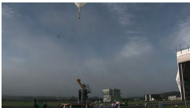
g) ウインチ繰り出し完了、制御紐切り離し。
