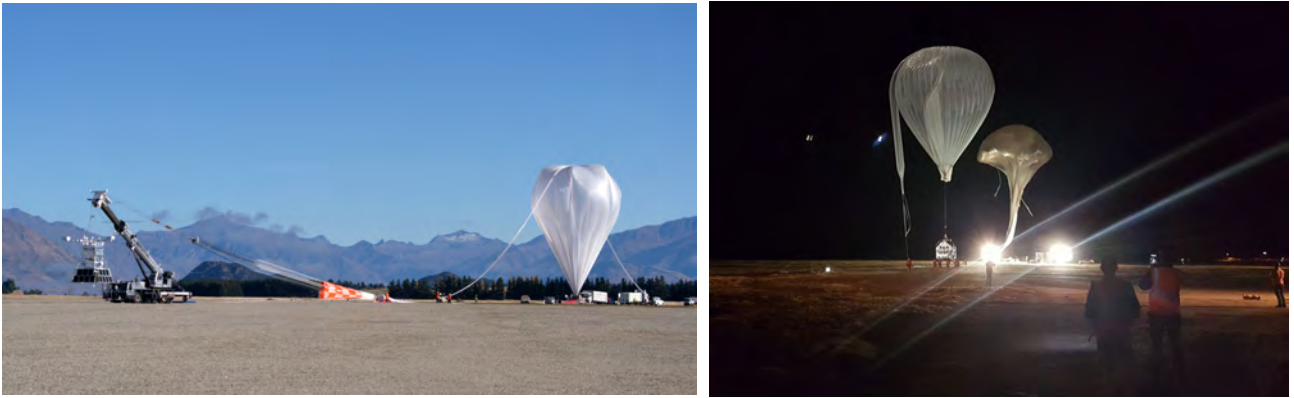
図 2: NASA によるダイナミック放球法での放球 [7]。 図 3: CNES による補助気球を用いた放球 [8]。
