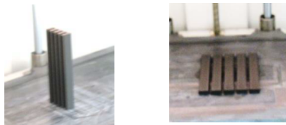
図10 CF短繊維入りのナイロン樹脂強度評価試験片 (左：面外方向積層、右面内方向積層)
