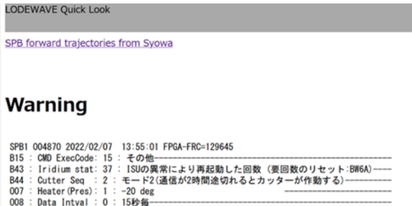
図2：ホームページ上のQLの冒頭の表示の例。Housekeepingデータのデフォルトと異なる部分のみ表示する仕様となっている。
