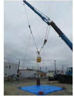
にその様子を示す。荷重の移行が吊り紐の繰り出しによって問題なく可能であること、第二保持点が十分な強度を有することが確認された。ただし、カラーの締め付け部において、気球の皮膜が損傷を受けることが見出された。これは、荷重に移行に伴って網が移動し、皮膜を傷つけたものと考えられる。そこで、カラー締め付け部の皮膜には、網との間に  $20\ \mu\text{m}$  フィルムを3枚挿入し、保護することとした。
