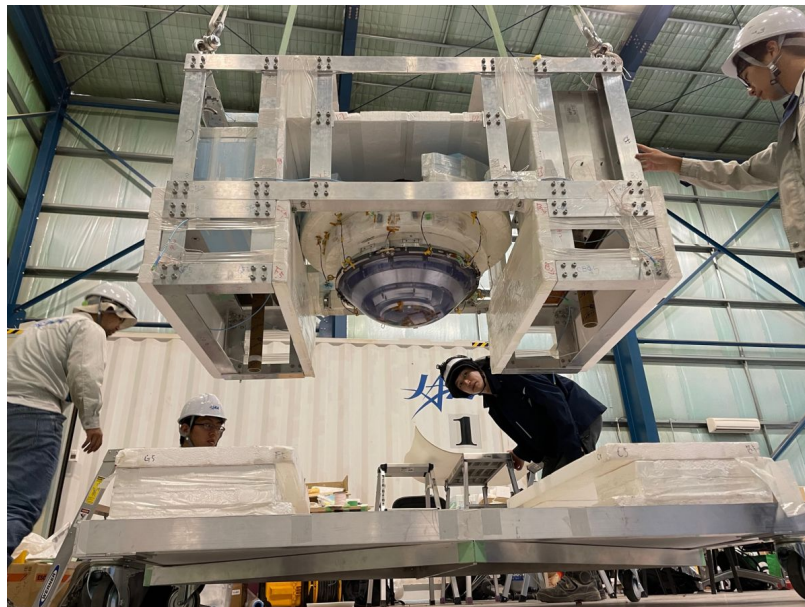
図15：ゴンドラに搭載された SRC 実験機を含む PI システム
