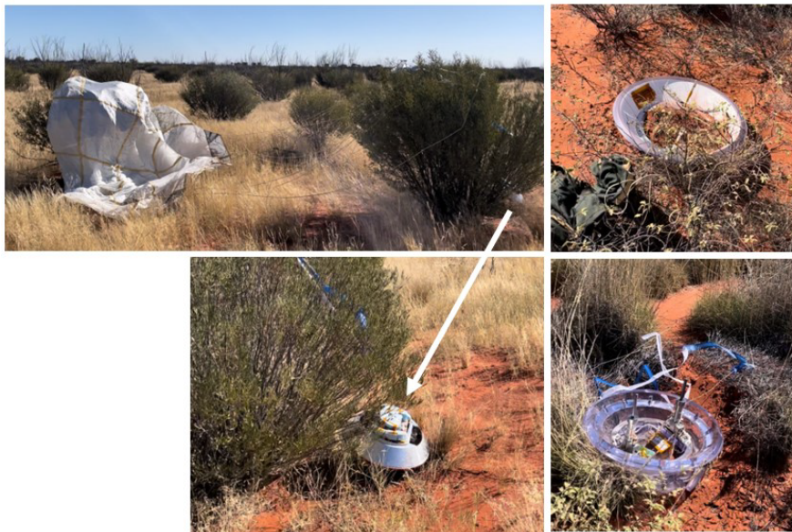
図22：回収時に発見されたカプセルの様子（左段：インスツルメントモジュールとパラシュート、右上：背面ヒートシールドダミー、右下：前面ヒートシールドダミー）
