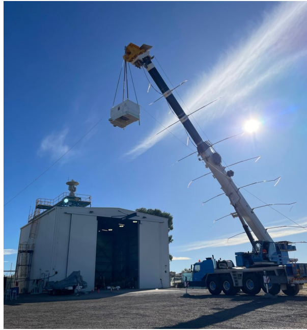
図16：感度試験のためにクレーンで吊り上げられたフライトレディの状態の SRC 実験のゴンドラ
