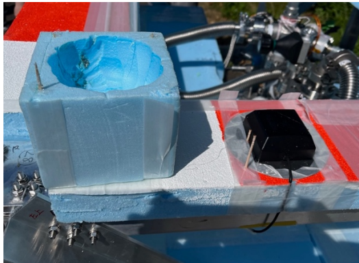
図5 アンテナのゴンドラへの取付
