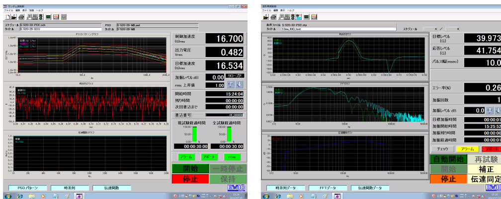
図4. PDC-CAM1 の振動/衝撃試験の結果 (Y 軸)
