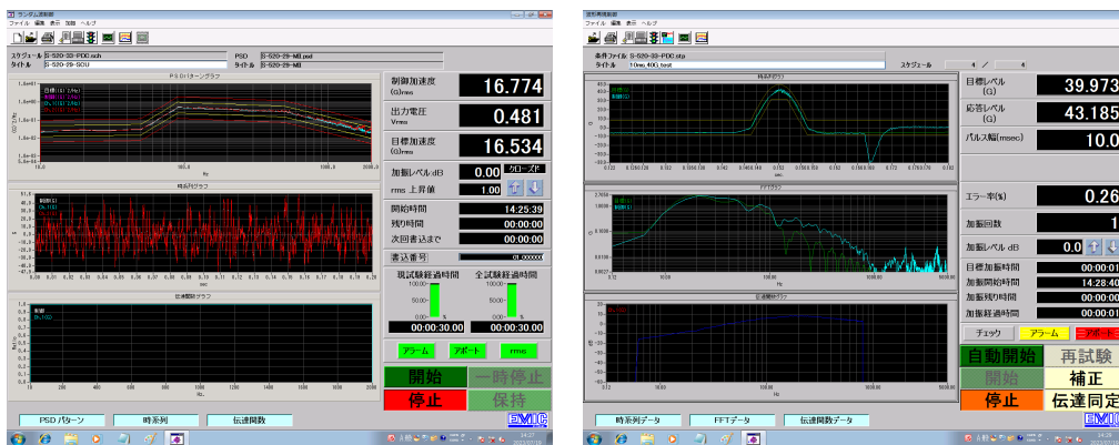
図 7. PDC-CAM2 の振動/衝撃試験の結果 (Y 軸)
