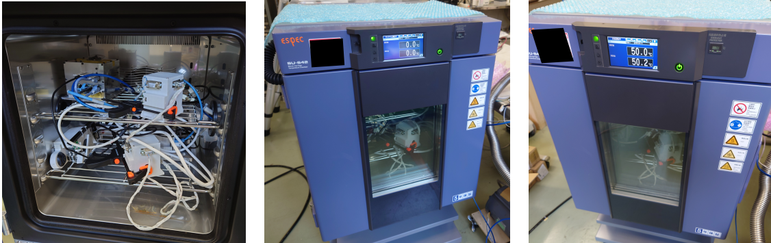
図10. 温度試験の様子. SU-642のモニターには試験器内の温度が表示されており, 要求温度を満たしていることがわかる. PDC-CAMと他のPDC機器と同時に試験をしている.
