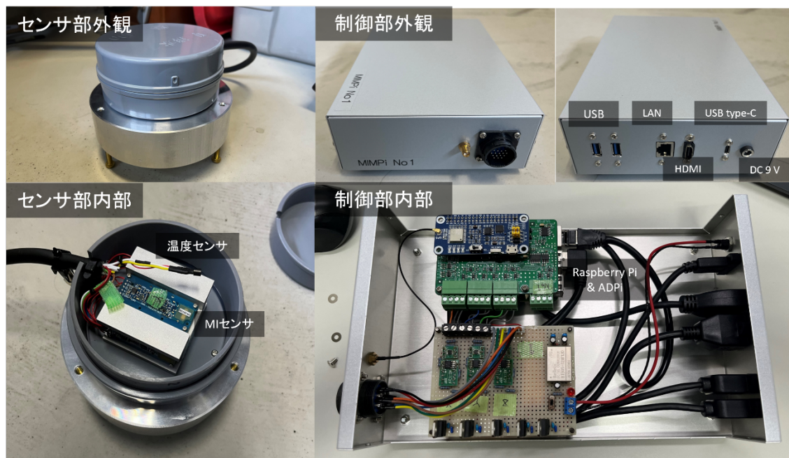
図 3 MIM-Pi の写真。(左)センサ部、(右)制御部。
