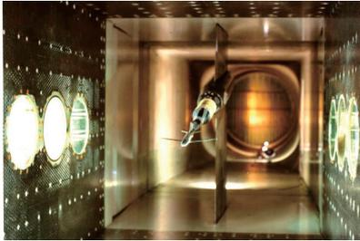
JAXA 遷音速風洞(回流型)
