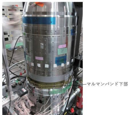
FEM予測値と静荷重試験の差は供試体と治具固定のボルト穴のガタ分ずれたのが原因
