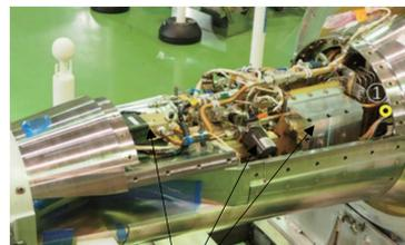
これらの供試体内部機器は、ランダム振動・衝撃試験で印加される振動・衝撃でも、機器に異常が生じないことを、事前に確認済。
