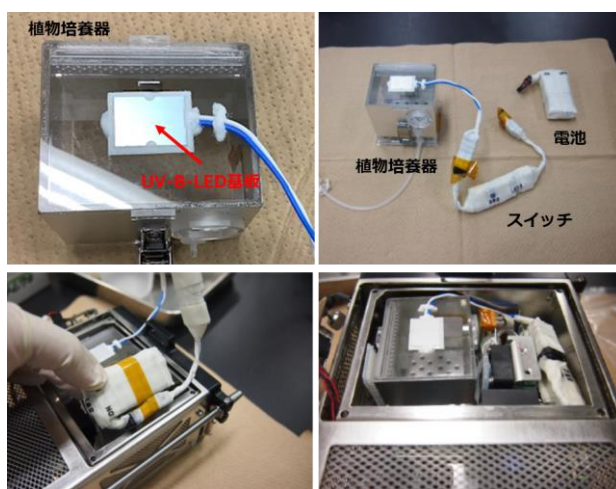
図1. 従来のPEUで使用していた植物培養器にUV-B-LEDを設置したUV-B照射型植物培養器の写真。上段左:UV-B-LED基板を植物培養器の上面に設置。上段右:UVB照射装置の構成。下段左:改造した植物培養器をPEUに設置している様子。下段右:PEUに収納した後の写真。
