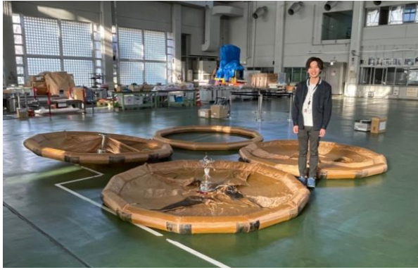
図3：RATS-L で使用した直径 2.5m のエアロシェル の回収後に実施した気密試験時の写真（一番手前の エアロシェルが RATS-L のフライト品）
