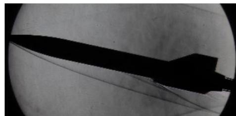
図 7. 極超音速風洞実験による衝撃波の可視化
