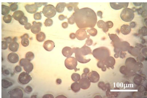
図5 AP/AN 共晶粒子（顕微鏡写真）
