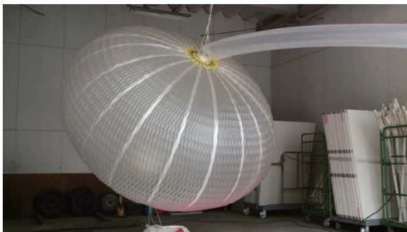
図 10: 破裂する直前の気球 (NPB001-2, 宇宙研車庫)
