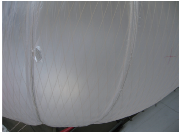
図 11: 気球の破壊箇所 (NPB001-2, 宇宙研車庫)
