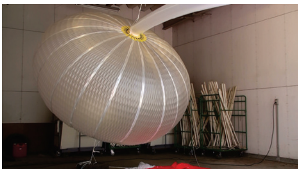
図 4: 破壊の様子, その 1 (NPB001-2, 宇宙研車庫)
