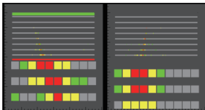
図 4 : シミュレーションによる電子イベント (10 GeV) のシャワーイメージ。左は X 方向、右は Y 方向から見た側面図である。上段は IMC、下段は TASC で、色の濃さはシャワー粒子による損失エネルギーを表しており、暖色になるほど各センサーにおける損失エネルギーが大きい。
