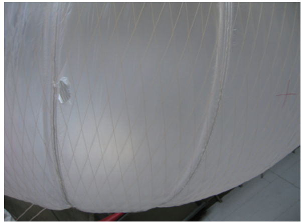
図 11: 気球の破壊箇所 (NPB001-2, 宇宙研車庫)
