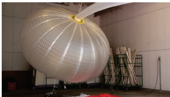
図 5: 破壊の様子, その 2 (NPB001-2, 宇宙研車庫)
