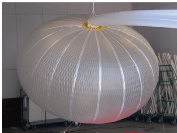
図 3: 満膨張の様子 (NPB001-2, 宇宙研車庫)
