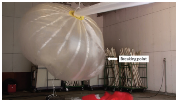
図 7: 破壊の様子, その 4 (NPB001-2, 宇宙研車庫) 網の縫合がはずれた
