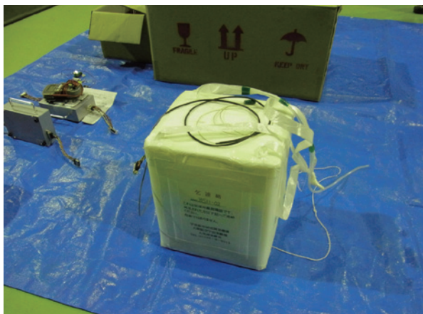
図 15: 放球直前の観測装置
