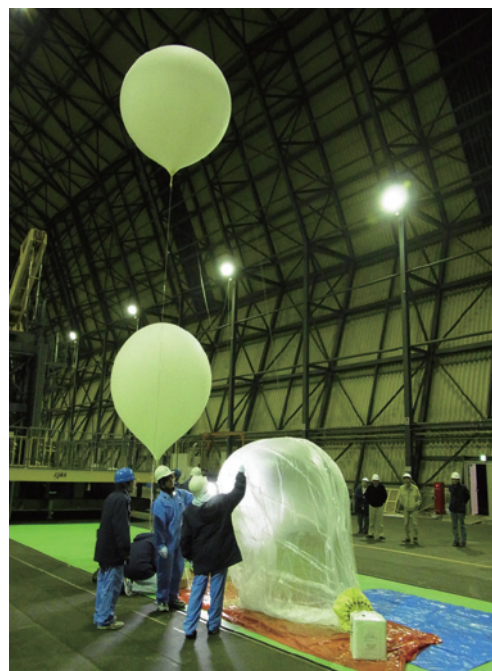
図 16: SP 気球へのガスづめ
