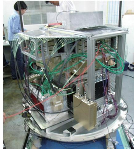
図3：bCALET-2装置写真。装置全体を円筒形の圧力容器（ベッセル）におさめるため、読み出し回路の下にDAQや高圧電源を設置し、電源装置はTASCの下に設置。
