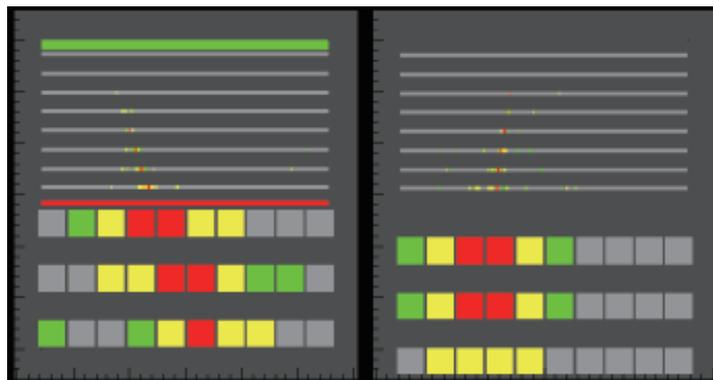
図4：シミュレーションによる電子イベント（10 GeV）のシャワーイメージ。左はX方向、右はY方向から見た側面図である。上段はIMC、下段はTASCで、色の濃さはシャワー粒子による損失エネルギーを表しており、暖色になるほど各センサーにおける損失エネルギーが大きい。
