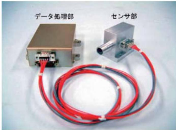
図3 飛翔体搭載用水晶摩擦気圧計 (QFG)
