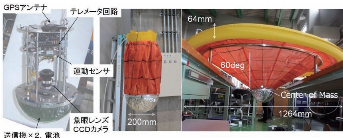
図 4. 本試験のために開発した実験機 (左：カプセル内部，中央：収納状態のアエロシエル，右：展開状態のアエロシエル)
