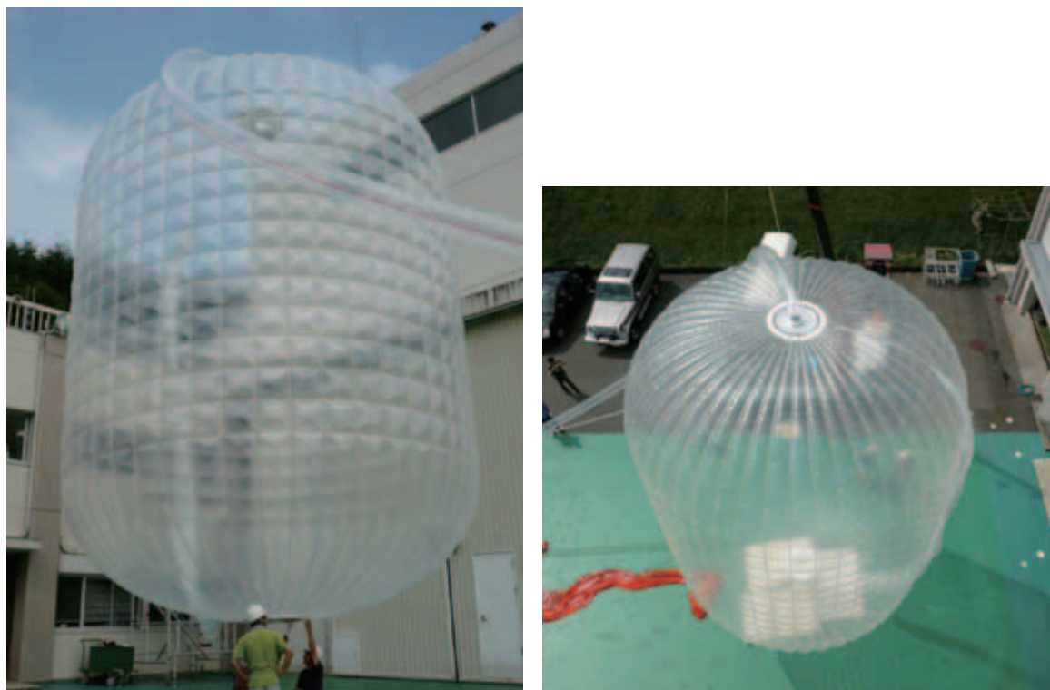
図 12 満膨張状態のモデル #2, 圧力差 200 Pa
