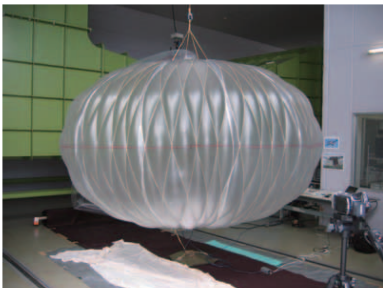
図 9: 破壊直前の気球 (NPB001-1)
