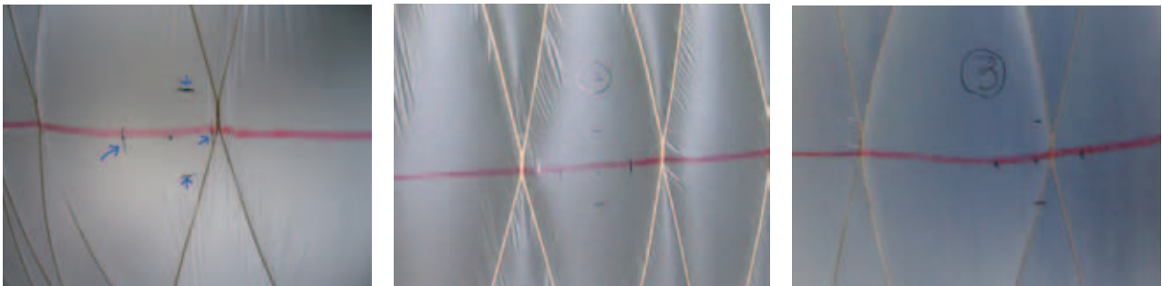
図 12: マークの位置. 左から順にマーク 1, 2, 3 の周辺の写真. 気球の赤道に赤線が入っており, ゴア幅の中央から縦横 5 cm づつ離れた点にマークが入っている (左図, 青矢印先). 膨張時に撮影したため, 変形している. マーク 3 の位置にはロープが被さっており, 横方向の曲率の計測はできなかった.
