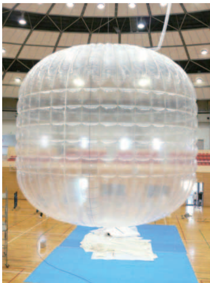
図 13 モデル #3 の膨張試験, 圧力差 200 Pa
