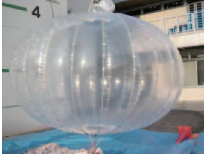
図 10 モデル #1 と同一直径の lobed-pumpkin 型気球の耐圧試験
