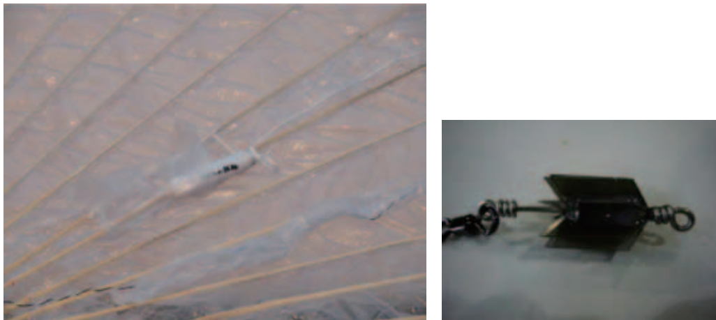
図 17 気球破壊装置の取り付け状態と破壊装置本体 (右)
