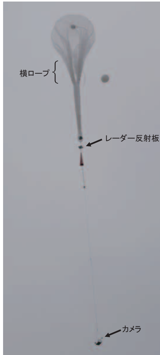
図 23 放球直後の気球、既膨張部の下側に横ロープが見えている
