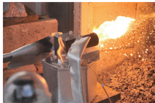
(B) X = +2.6\text{s} テルミット剤に伝火開始
