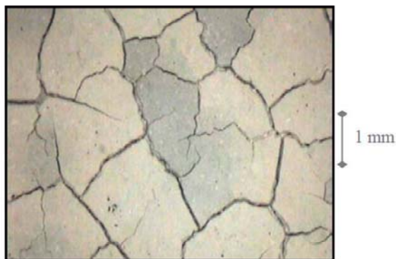
図 1-19 高温曝露 (350 °C、518 h、真空中) 後における白色塗料 (Z-93-C55、Al 基板) の表面[85]
