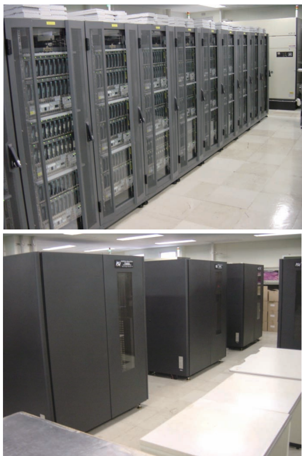
図 3.13 CeMSS におけるディスクとテープ装置
