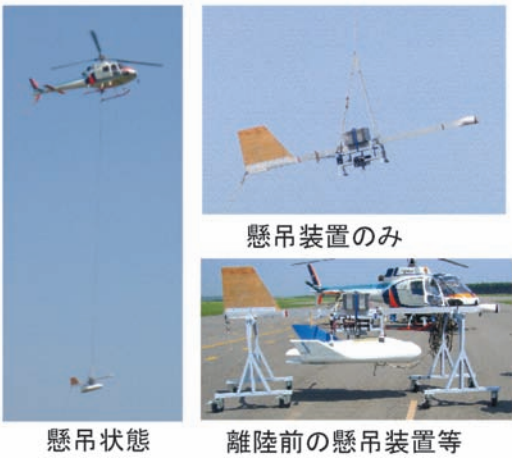
図 3.3.2-2 実験機を懸吊した懸吊装置と地上での支持台
