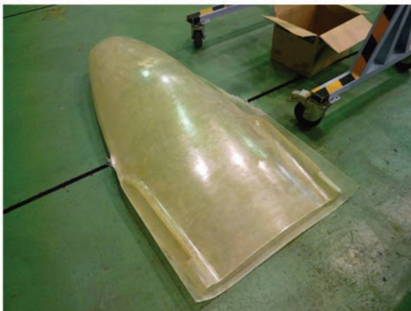
図 3.2.1-5(a) GFRP 機体
