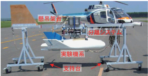
図 3.3.2-4 懸吊装置、支持台および実験機
