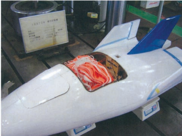
図 4.2.2-1 質量・質量中心計測（水平面内）
