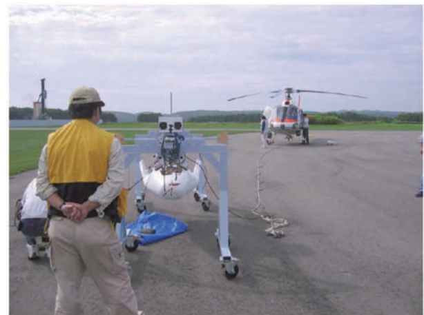
図 4.3.3-9 母機ヘリコプタ + 懸吊装置 + 実験機の電磁適合性試験状況
