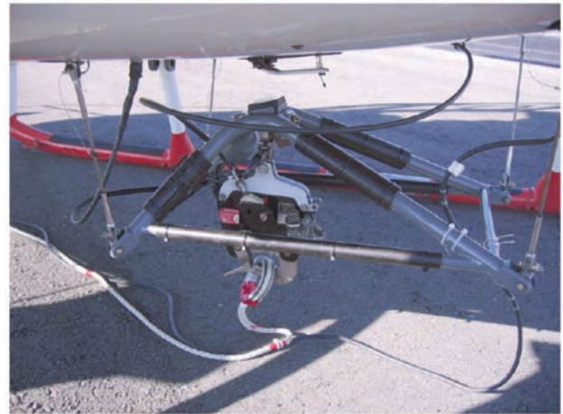
図 2.4.1-1 AS350B の懸吊機構
