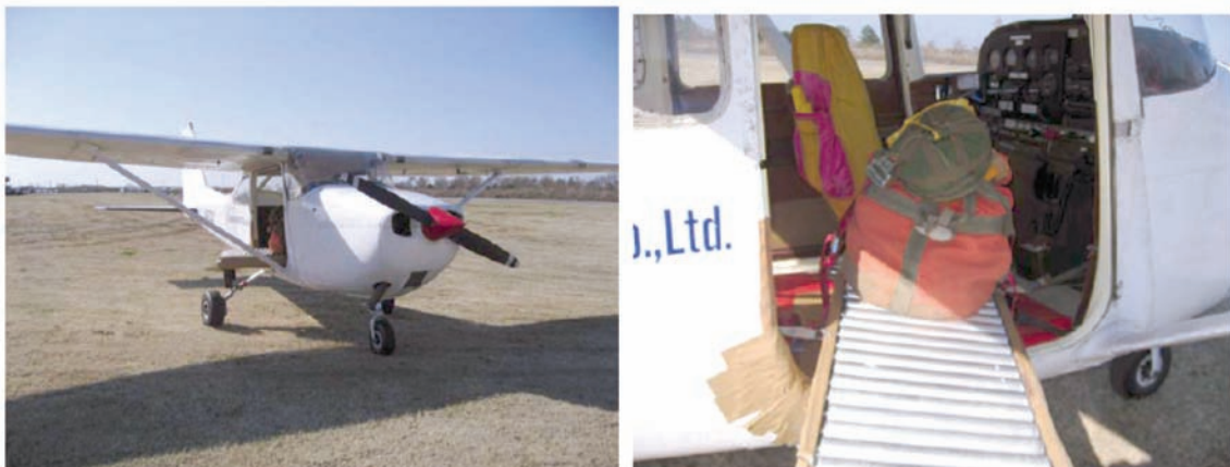
図 4.2.8-4 投下レール取付状況とパラシュート・ダミー計測器一式投下準備状況
