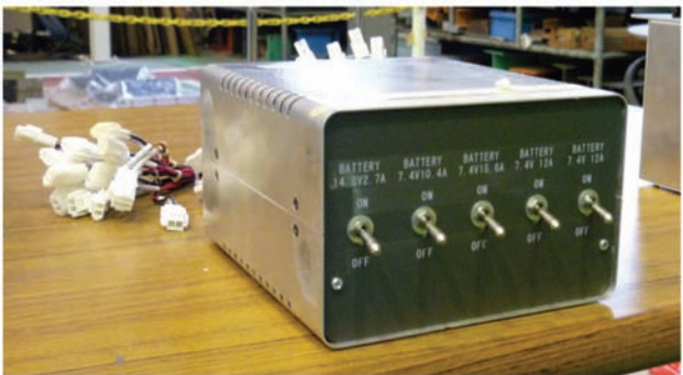
図 3.2.2-8(b) 電力分配器 (写真)
