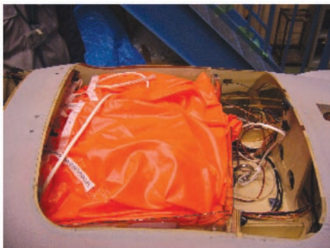
図 3.2.3-6 パラシュート格納状況 （中央アクセス扉を外した状況）
