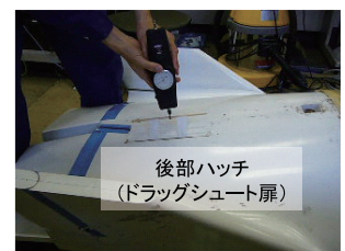
図 3.2.1-7 パラシュート扉耐荷重試験
