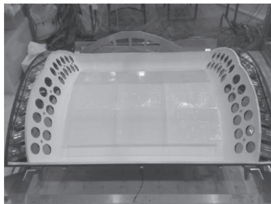
図 13 エアロジェルチェレンコフ測定器の内部。内部に置かれたエアロジェルブロックからの光を 48 本の PMT でとらえる。
