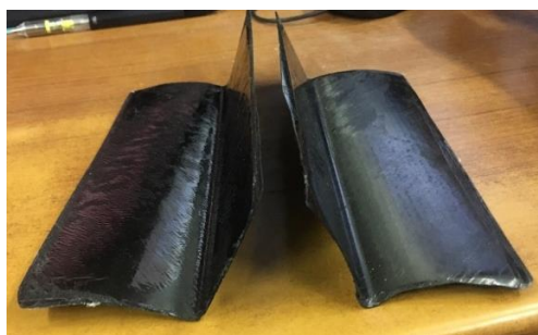
図10 CFRPフィンステー
