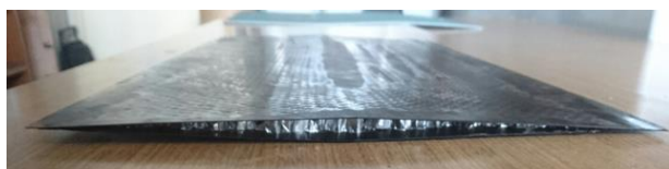
図8 CFRPハニカムサンドイッチフィン
