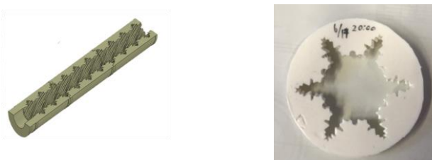
図15 星型フラクタル旋回形状グレイン (左；軸方向断面，右；円周方向断面)
