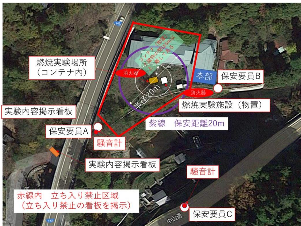
図 6 燃烧試験時の配置図
