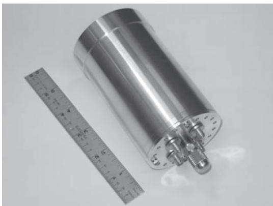
図 14 TOF 用 PMT のためのアルミ製気密容器。上空で内部を常圧に保ち、高電圧の放電を防ぐ。
