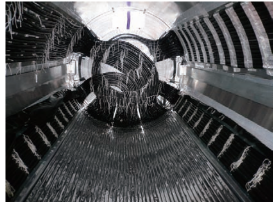
図 11 ファイバーの取り回し。下に敷き詰められているのが MTOF のシンチレータ本体。上部に物質がこないように工夫されている。
