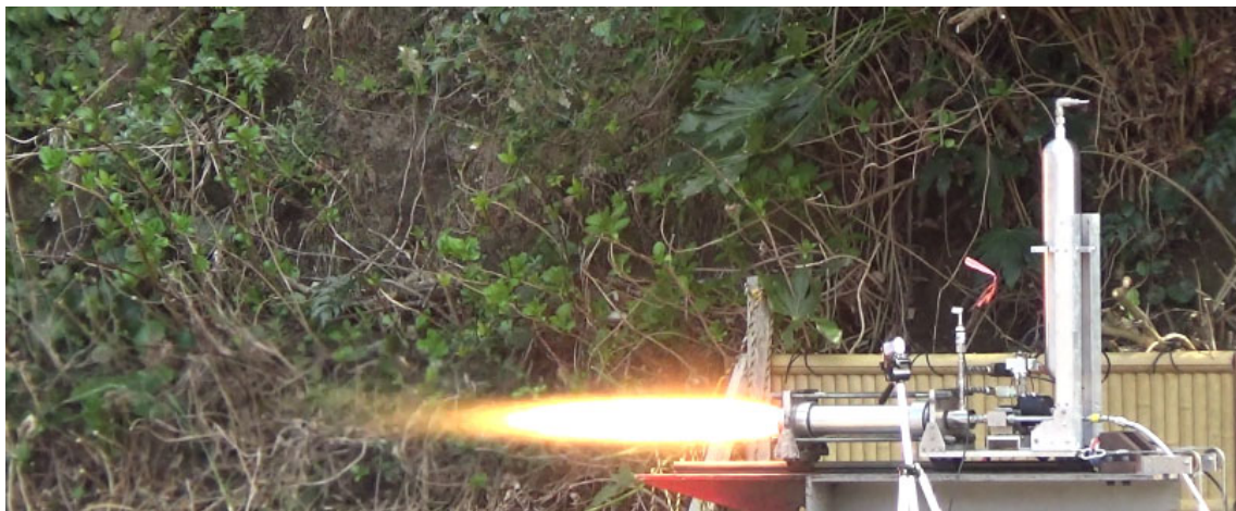
図19 1.5kN級ハイブリッドロケットモータの燃焼実験の様子
