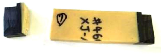
b) 凝集破壊する#460
