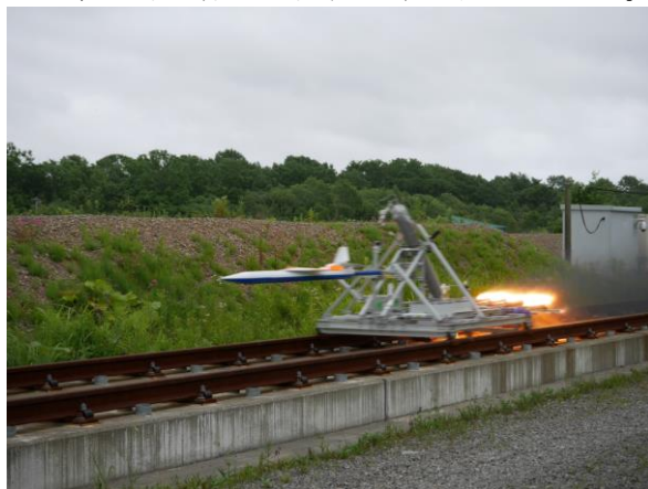
図1 ロケットスレッド走行の様子 (Run028 小型 UAV 操舵面空力特性試験 1kN グレーンを4本使用)
