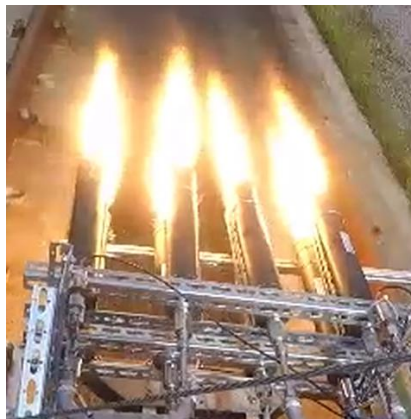
図10 走行中のハイブリッドロケットエンジン (Run037)
