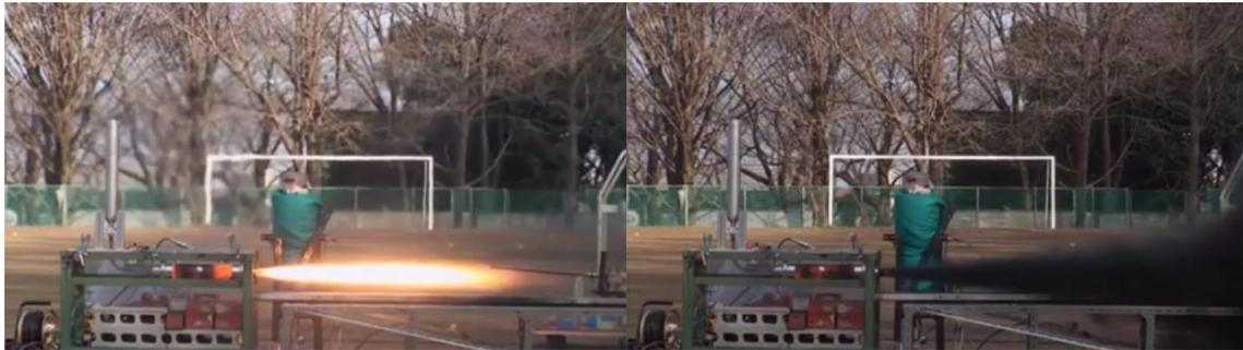
Fig. 1 地上燃焼試験における燃料崩落時の様子
