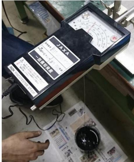
Fig. 5 アナログ式ビスコメーターを用いた粘度計測の様子
