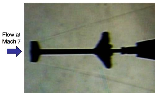
図9 膜面エアロシェル展開ロケットのマッハ7極超音速風洞シュリーレン写真
