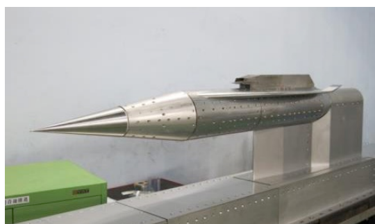
図14. RJTF 用 HIMICO 実験模型
