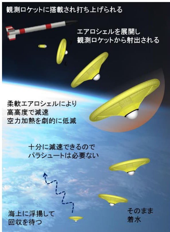
図 2 : 展開型柔軟エアロシェルを利用した観測ロケットデータ回収システムの概念図
