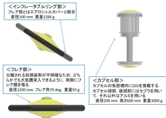
図 3 : S-520-31号機でのデータ回収用に設計した展開型柔軟エアロシェルを利用して回収モジュールの概念設計結果
