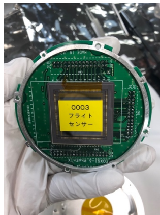
図 8. 軟 X 線観測用の裏面照射型 CMOS 検出器。(© FOXSI-3 team)
