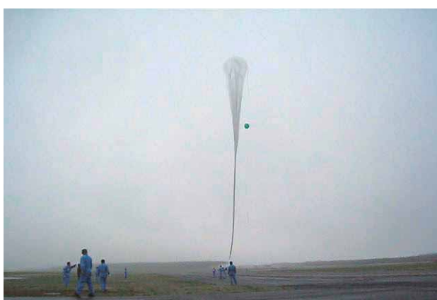
図 30 大樹航空宇宙実験場における最初のポリエチレン気球となった測風 BS08-03 の放球風景
